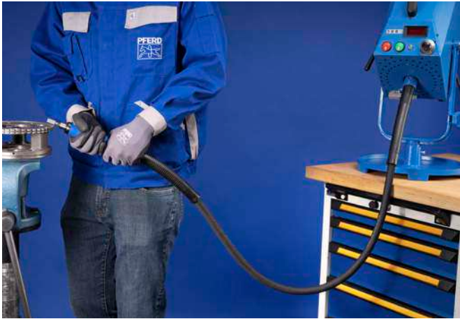
Richtiges Aufstellen des Biegwellenantriebes: Sanfter Schwung der Biegwelle ohne abgeknickte Stellen.
