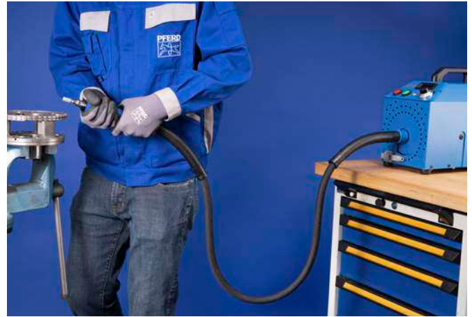
Falsches Aufstellen des Biegwellenantriebes: Biegwelle Motor- und/oder Handstückseitig abgeknickt.
